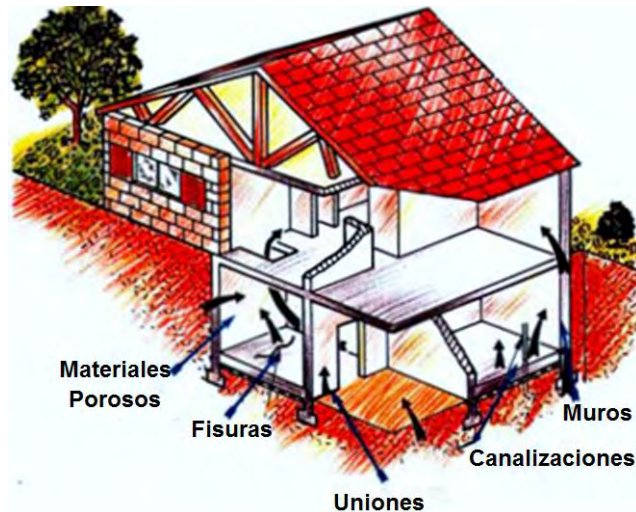
Fig. 1.4 Principales fuentes y formas de transporte de radón en una casa, Fuente: El radón un gas de origen natural en su casa , Quindós 1995.
