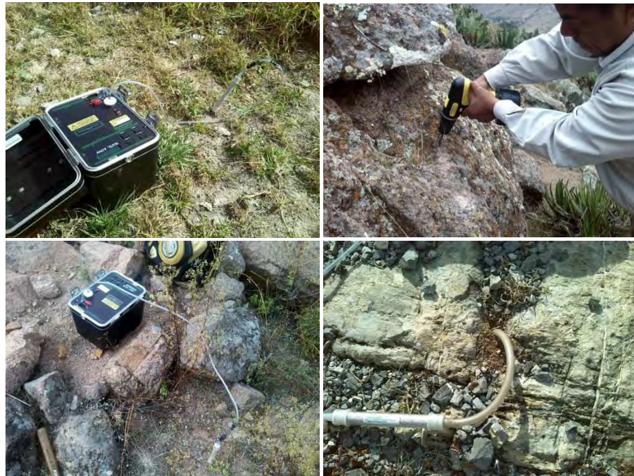
Fig. 3.2 Toma de muestras en suelo y roca con el equipo RAD7.
