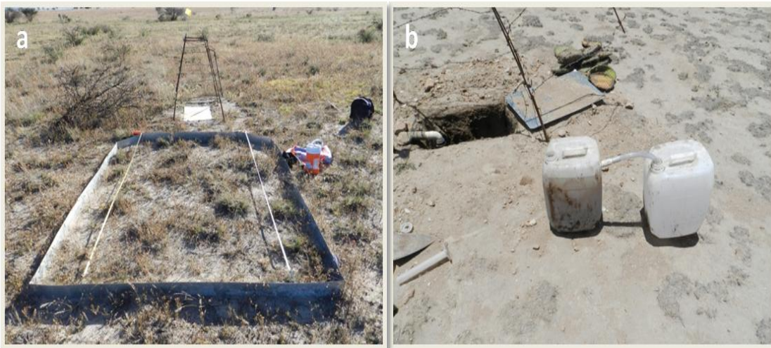
Figura 2. Sistema de camas de escorrentía con los garrafones colectores de escorrentía.
