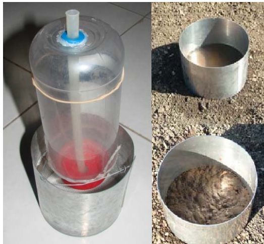
Imagen 2. Infiltrómetro de anillo simple.
