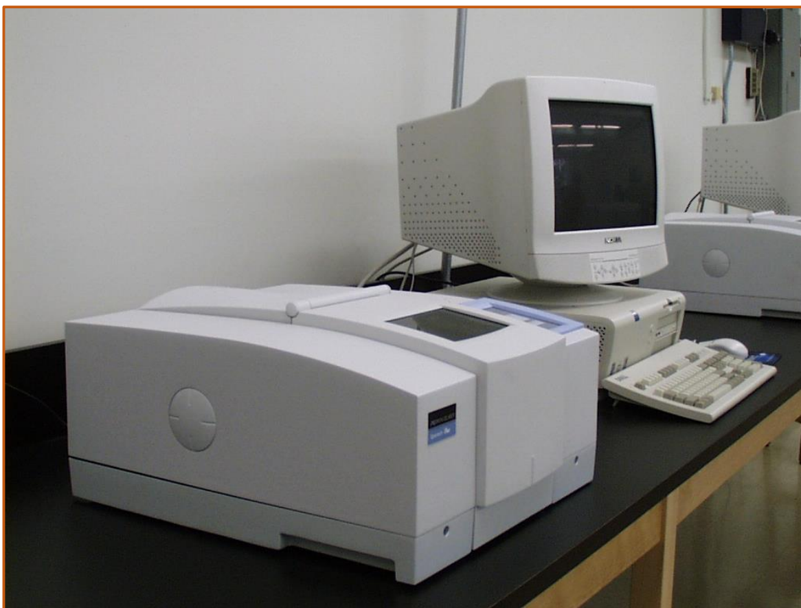
Figura 9. Espectrómetro Perkin Elmer, modelo Spectrum One 59081.
