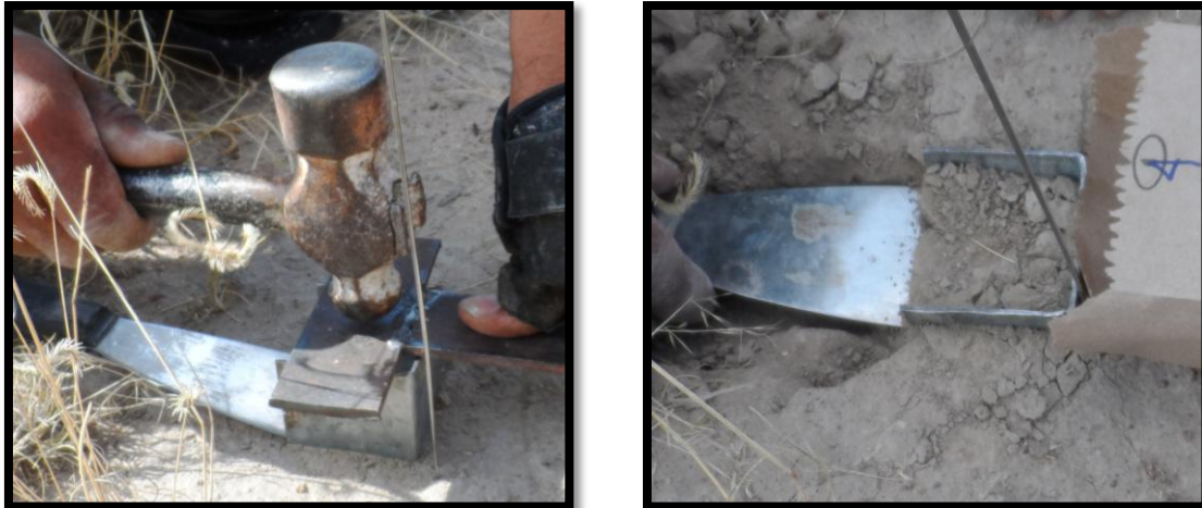
Fig. 2.5 a, b. Extracción de las CBS por individuo y profundidades de suelo. a) La imagen de la izquierda muestra la inserción del molde de metal al suelo. b) En la imagen de la derecha se muestra la extracción de la costra así como las tres profundidades de suelo con la ayuda de una espátula.
