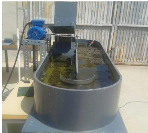
**Figura 1.3.** Sistema de cultivo abierto tipo *Raceway*.
