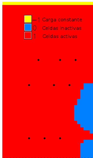
Figura 5.2: Condiciones de frontera.
