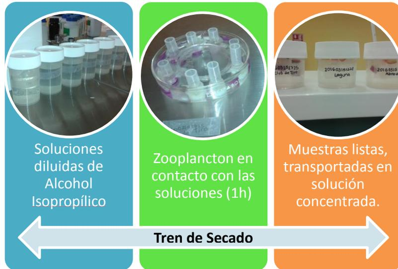
**Figura 12** Proceso de tren de secado.
