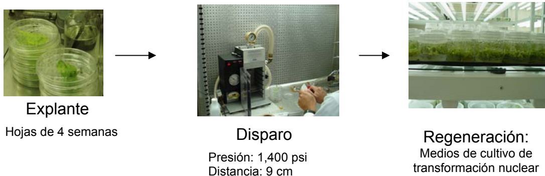
Figura 33. Proceso de transformación de hojas de tabaco por el método de biobalística.
