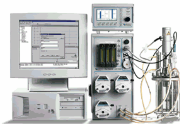
Figura 3-1. Sistema de fermentación.
